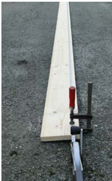
3) Mit Maßband Lattenabstände auftragen
